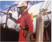
5.2.9) Equipos de protección respiratoria de oxígeno comprimido o de oxígeno-nitrógeno comprimido, con botellas portátiles (De circuito cerrado)
