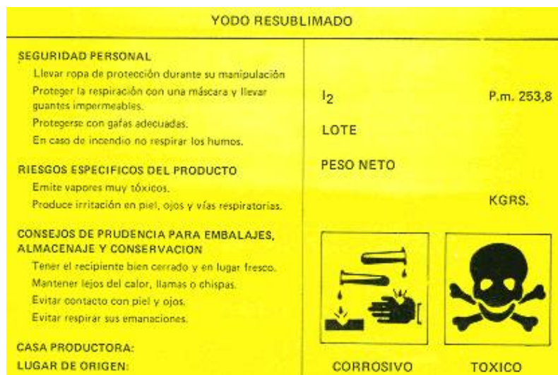
Ejemplo real de etiqueta de un producto corrosivo y tóxico
