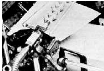
Fig. 11: Detalle de barra de alimentación automática de una Minerva (Fuente Heidelberg)
