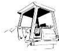
b) Estructura con 4 puntales con techo
