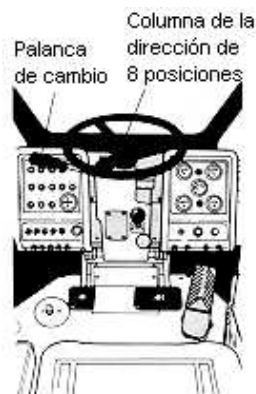
Fig. 5: Mandos pala cargadora sobre orugas (Fuente Caterpillar)
